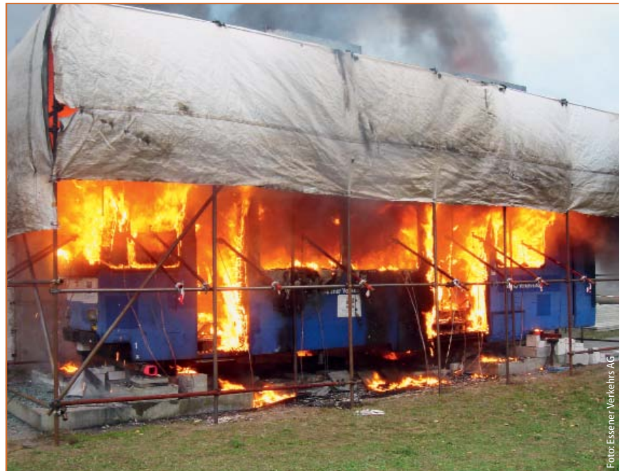
Abb. 4: Realbrandversuch an einem Schienenfahrzeug bei der MFPA Leipzig
