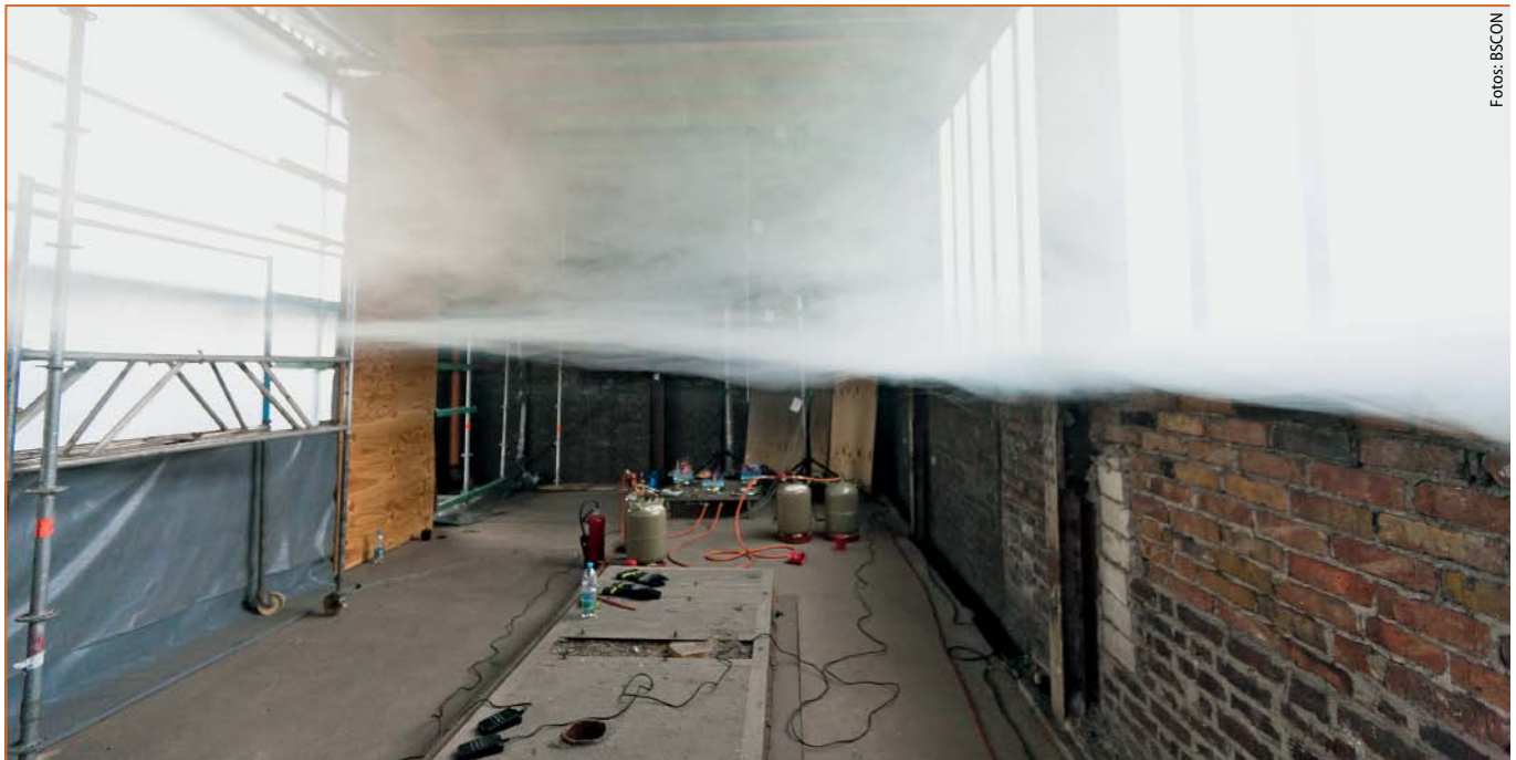
Abb. 1: Rauchschichtung im Versuchsmodell für eine unterirdische Verkehrsanlage
